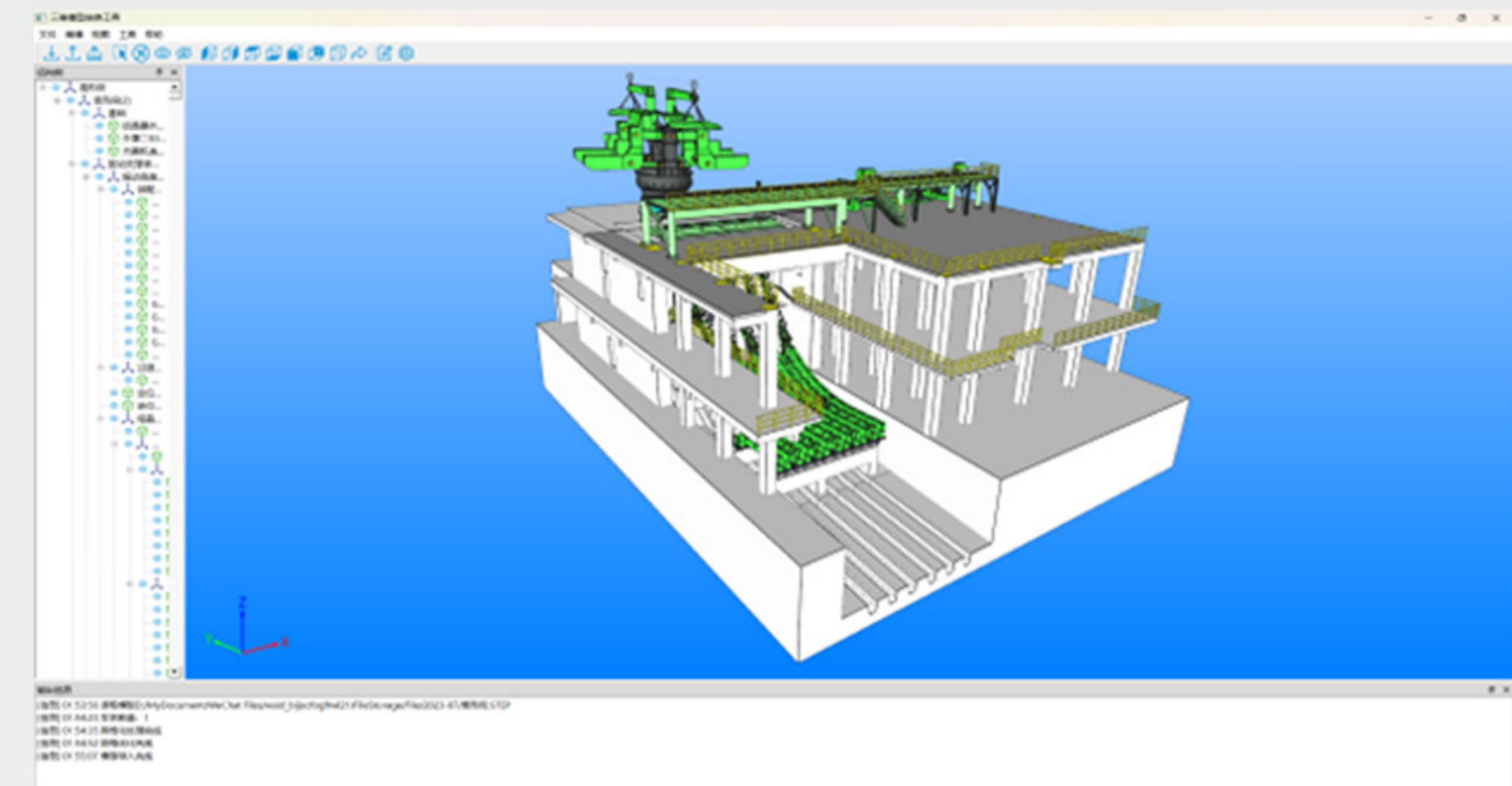
在保证模型外观与质量的前提下对模型进行网格精简、结构优化、冗余去除等操作，提供了丰富的优化参数，能够生成适应 PC、移动设备、网页等不同终端的多精度轻量化网格模型，并导出常用的三维模型文件及模型结构信息。
